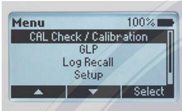
Funciones avanzadas como CAL Check™ para verificar el rendimiento, GLP para la última fecha de calibración, configuración y posibilidad de ver todos los accesorios utilizados con el medidor.
