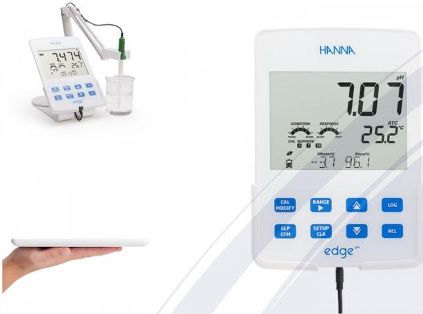
El HI2002 es un innovador pH-metro que ofrece precisión y versatilidad con el precio más competitivo. Además de pH puede medir potencial redox (ORP) con el electrodo ORP opcional adecuado, reconociendo automáticamente el sensor digital conectado, sus datos de calibración y número de serie. Puede utilizarse como equipo de sobremesa, pared o tableta portátil.
